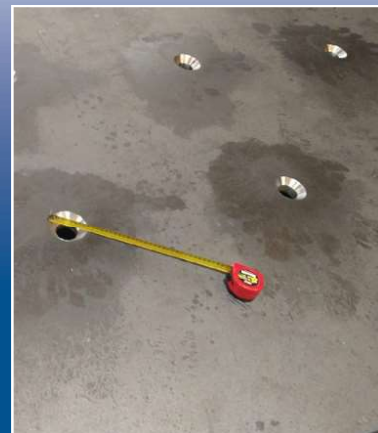
Foratura e svasatura a interpolazione per asportazione truciolo
