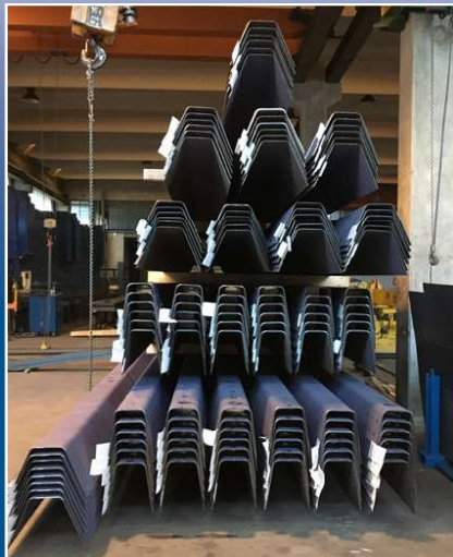
Lamiera tagliate al plasma HD e pressopiegate
