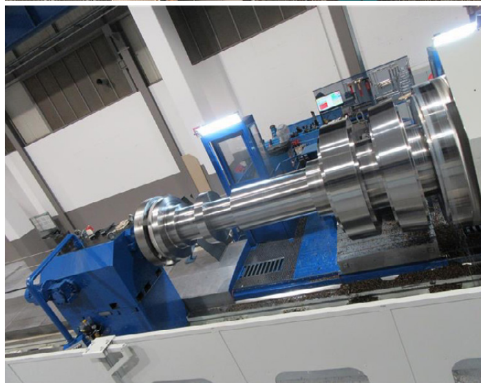
Lavorazione interna del particolare Tornitura albero rotore
